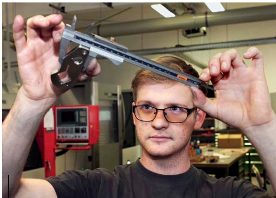
Der Auszubildene Peter Jaschenko prüft mit der Schieblehre ein Werkstück.
